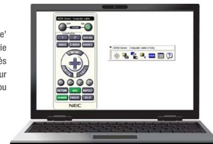
Le logiciel 'Virtual Remote' de NEC, fourni avec tous les modèles de la série U, offre le contrôle total du projecteur via une télécommande virtuelle à l'écran, depuis un PC relié par câble VGA, en réseau. Cette fonctionnalité est particulièrement utile dans un environnement de salle de cours ou de formation, où les pertes de télécommande sont courantes.
